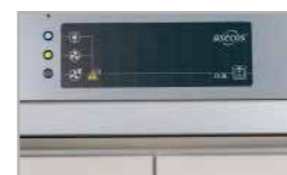
Frånluftsovervakning med visuellt och hörbart larm.
