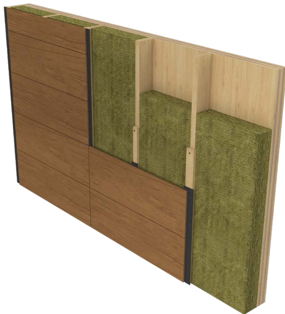
UNDERKONSTRUKTION AV TRÄ
